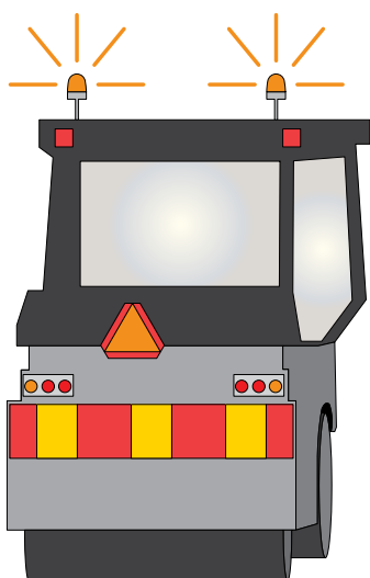
Utmärkning av arbetsfordon utanför skyddsområdet vid fasta arbeten, till exempel vid belägningsarbete med dubbellots.
